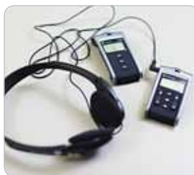
Trådlöst tolksystem med sändare och mottagare.
