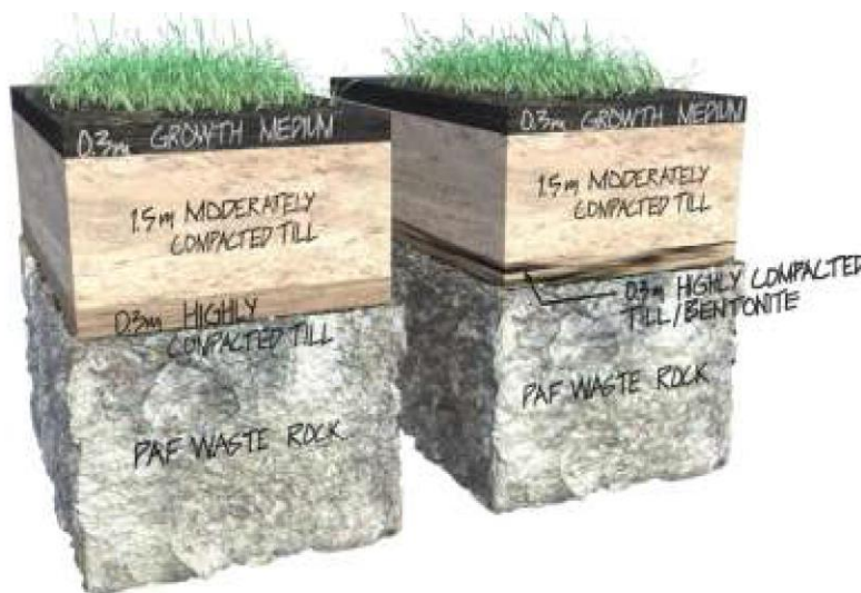
Figur 3. Konceptuell figur av täckningarna som används för base case och bentonite case.
