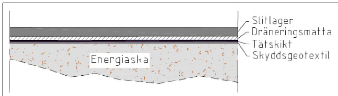
Figur 4, Sektion över behandlingsyta uppbyggd av energiaska.
