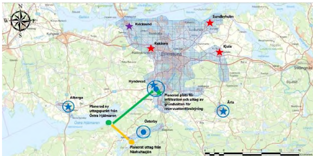
Figur 1. Kommunal dricksvattenförsörjning i Eskilstuna kommun. Blå cirklar anger ungefärligt läge för aktiva kommunala vattenverk och blått raster anger ungefärligt försörjningsområde för respektive vattenverk. I figuren anges uttag av grundvatten i isälvsavlagring med blåa stjärnor och uttag av ytvatten med blå prickar. Tidigare kommunala vattenverk anges i röda respektive lila stjärnor. Planerade uttagspunkter, råvattenledningar och plats för infiltration samt uttag av infiltrerat grundvatten i isälvsavlagring för planerad reservvattenförsörjning visas i grönt och gult.
